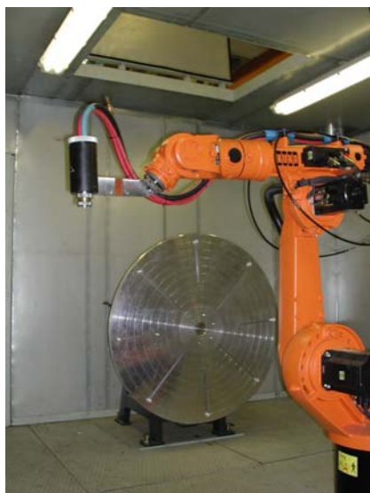
Установка для плазменного напыления ТСЗП – MF- P-1000 с манипулятором
