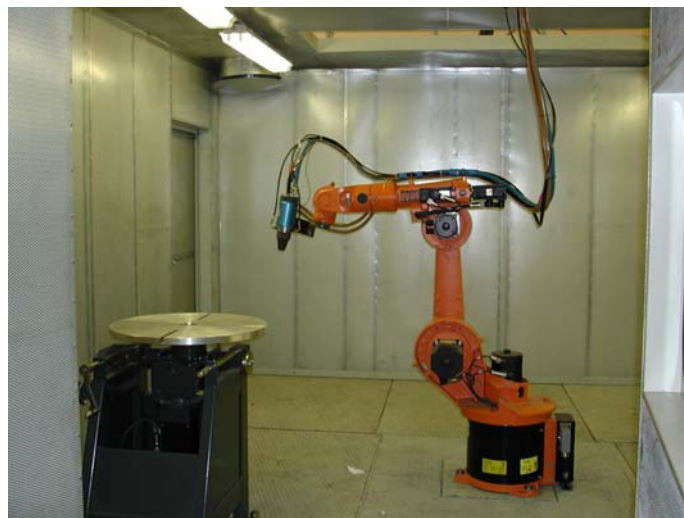
Установка для высокоскоростного газопламенного напыления ТСЗП –HVOF-K-2 с манипулятором
