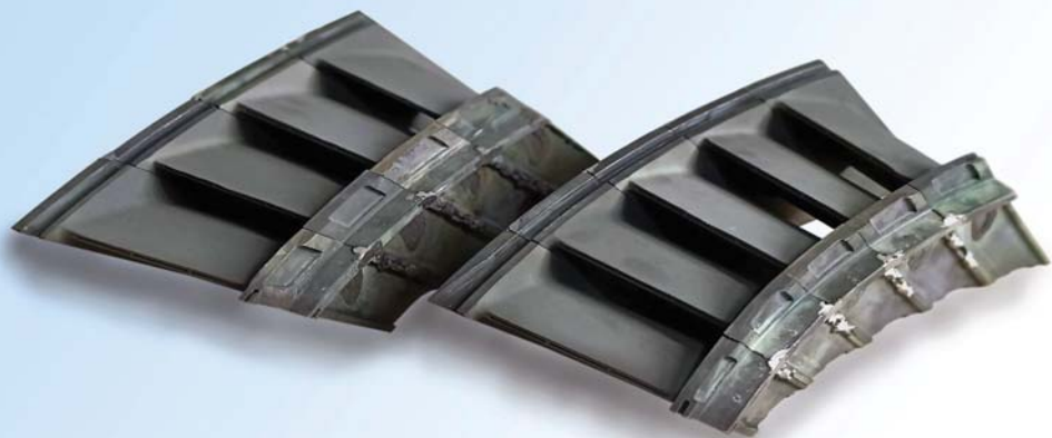
Фото 4. Сегменты НЛ после восстановительного ремонта и нанесения жаростойкого покрытия
