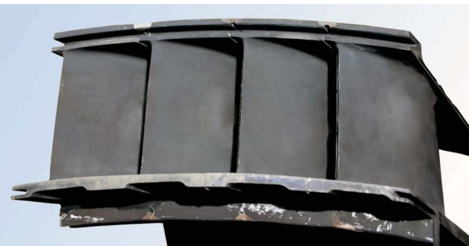
Фото 3. Пример сегмента НЛ, поступившего в ООО «ТСЗП» на восстановительный ремонт
